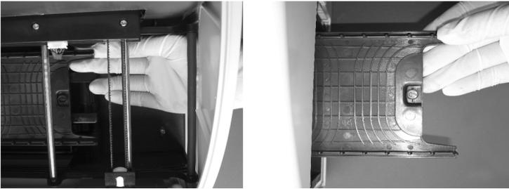
Reinigen Sie sämtliche sichtbaren Probenrückstände mit einem in destilliertes Wasser getränkten Wattebausch oder mit einer Wattekugel. Trocknen Sie diesen mit einem sauberen, trockenen Wattebausch ab.
