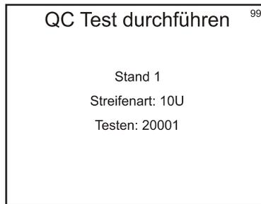
Der Analysator führt zunächst einen QC Test der Stufe 1 durch. Siehe auch der Abschnitt Teststreifen für weitere Testdetails.
